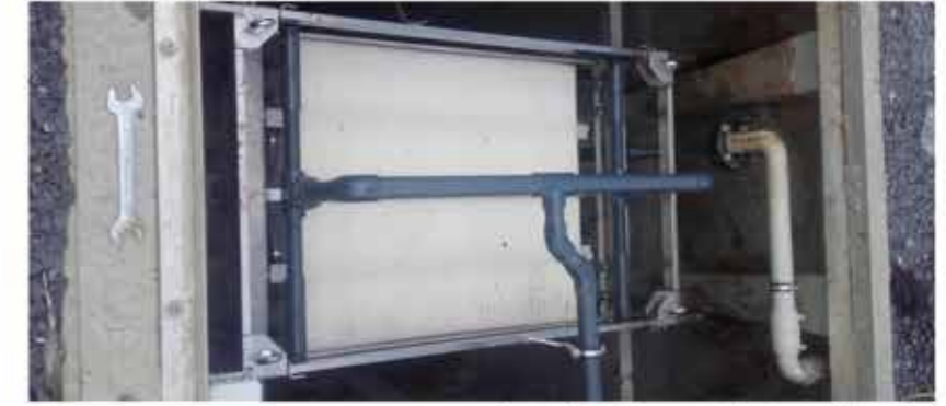
réacteur à membranes de la brasserie Lupulus
