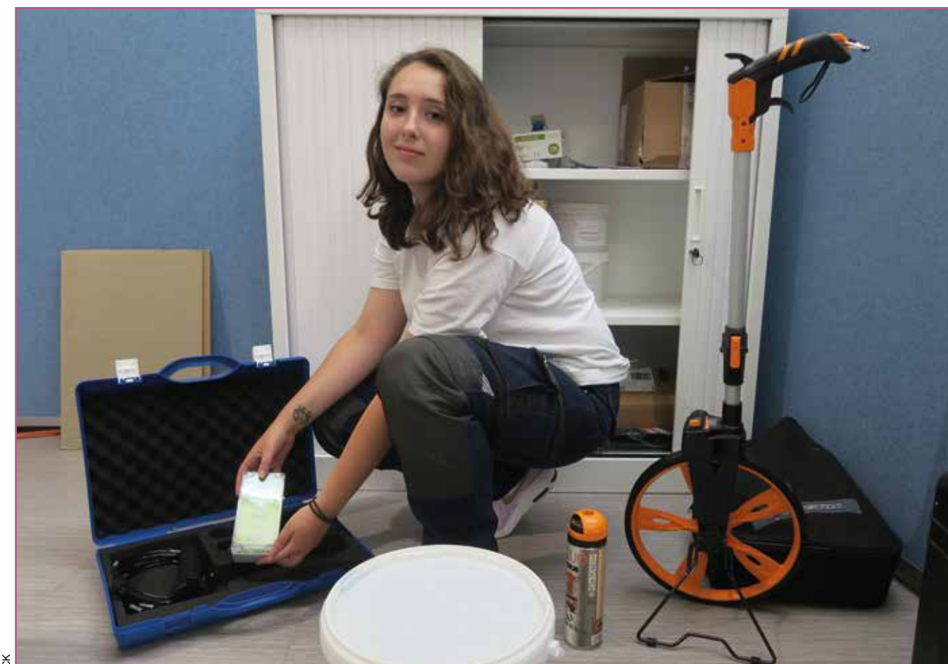
Parmi les outils dont dispose le Spanc, une roue pour mesurer les distances et un contrôleur portable du niveau de boue tout neuf.
