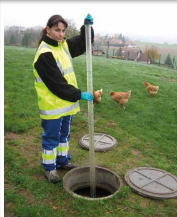
La mesure de la hauteur de boues peut se faire à l'aide d'une simple canne graduée, d'une sonde à voile de boue ou, dans le cas présent, d'une canne de carottage.
