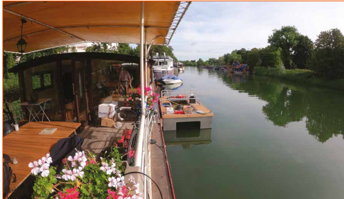
La Phytoflottante, installée dans le petit radeau amarré à la péniche, traite avant rejet toutes ses eaux usées, quelles que soient les conditions climatiques et la hauteur du fleuve.
