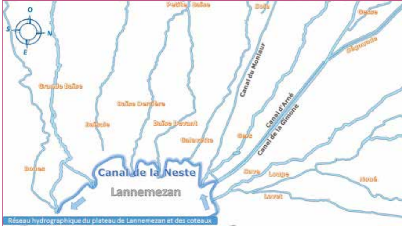
Le plateau de Lannemezan est un véritable château d'eau. C'est ici que naissent les principales rivières des bassins de la Garonne et de l'Adour. Il est traversé par le canal de la Neste : un réseau hydraulique long de 29 km, construit au milieu du XIX e siècle pour partager l'eau des Pyrénées entre quatre départements. Aujourd'hui, cet ouvrage est géré par la Compagnie d'aménagement des coteaux de Gascogne. NB : sur ce schéma, le nord est à droite.
