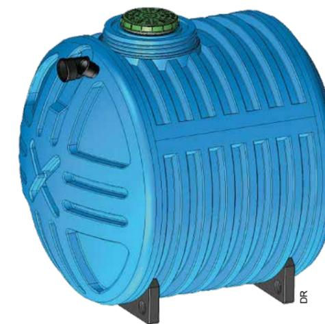
haute intégrée. Ces cuves sont résistantes aux montées de nappe ainsi qu'aux charges de remblai jusqu'à 80 cm, grâce à la forme alvéolaire de la double peau externe. La pose en zone de circulation est ainsi autorisée. Et s'il n'y vraiment pas de place autour de la maison, le particulier peut toujours installer sa cuve dans la cave, sur des pieds de stabilisation prévus à cet effet. ■
