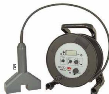
Le niveau est affiché en centimètres, une diode rouge prévient l'utilisateur lorsque la sonde détecte le voile de boues. ■
