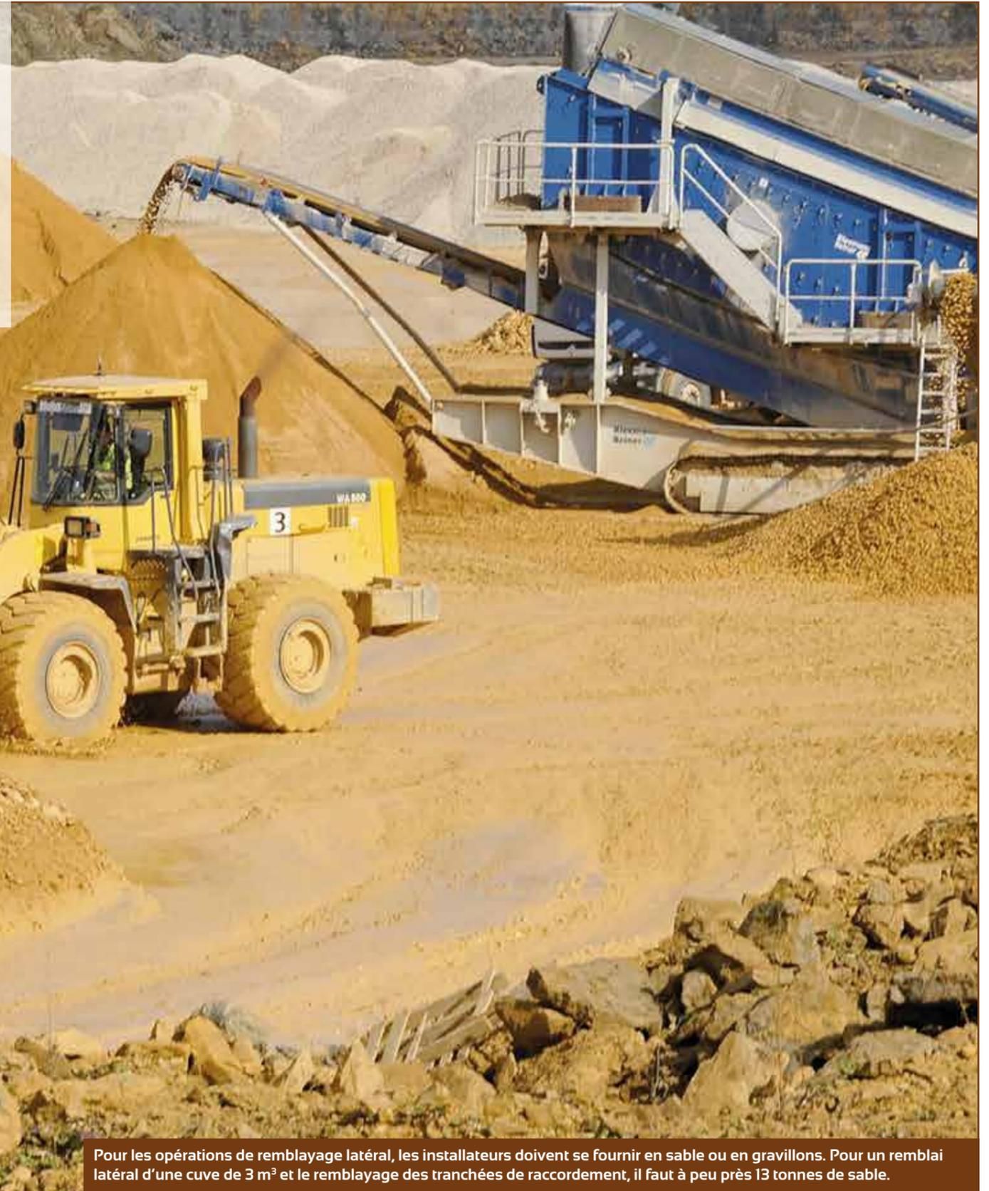
Pour les opérations de remblayage latéral, les installateurs doivent se fournir en sable ou en gravillons. Pour un remblai latéral d'une cuve de 3 m<sup>3</sup> et le remblayage des tranchées de raccordement, il faut à peu près 13 tonnes de sable.
