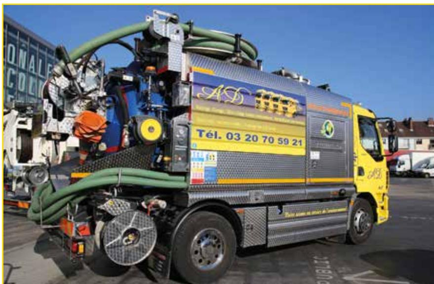
l'acquisition d'un camion de déshydratation de 26 tonnes destiné au recyclage des boues, des graisses et des matières de vidange.
