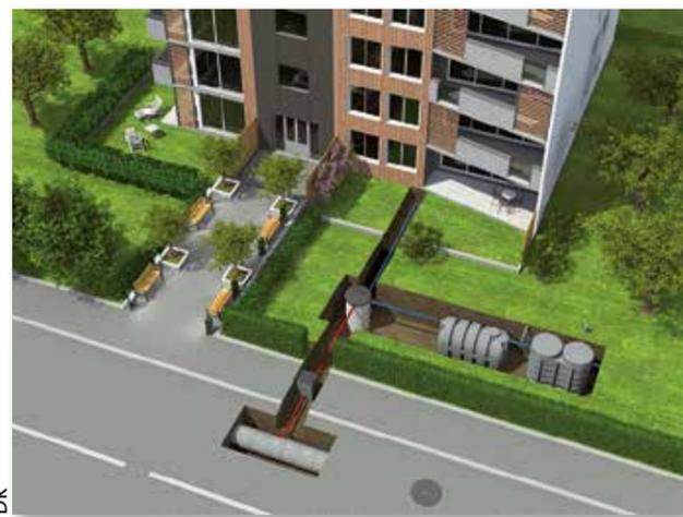
**C**E SPÉCIALISTE de l'ANC présente deux nouveaux modèles de sa gamme de postes de relevage Drain'Up, pour le relevage des eaux usées des maisons individuelles ou des lotissements. Les cuves sont en polyéthylène à haute densité, d'une capacité de 344 l pour le modèle D51UP et de 610 l pour le modèle D61UGP. Tous deux mesurent 1,46 cm de hauteur, le diamètre du socle pour le D51UP est de 60 cm, alors que celui de l'autre modèle atteint 80 cm.
