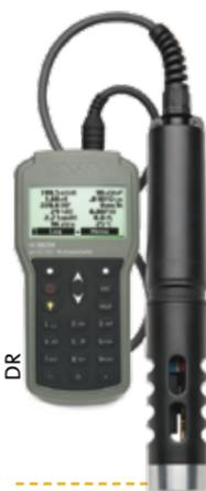
C'EST un luxe que peu de Spanc peuvent se permettre, mais c'est pourtant un outil rapide et sûr pour contrôler le bon fonctionnement des installations d'ANC. Le HI 98194 est un appareil de mesure multiparamètre portatif étanche qui sert à contrôler le pH et la température et à calculer la DBO5 des dispositifs. Il peut mémoriser jusqu'à 45 000 mesures en mode
