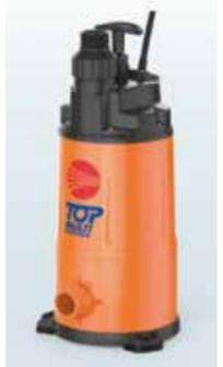
La pompe Top Multi-Evotech répond sur ce point aux exigences du secteur. Le débit maximal de la pompe est de 7,2 m<sup>3</sup>/h pour une pression de 1,5 bar. Elle est destinée au pompage des eaux claires, en sortie de microstation ou d'une étape de traitement drainée pour permettre le rejet des eaux usées traitées. Le corps de la pompe est en technopolymère renforcé de fibre de verre, l'arbre du moteur est en inox.
