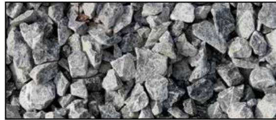
et ses graviers filtrants sont des matériaux siliceux avec une teneur en calcaire inférieure à 20 % en masse et une teneur en fines qui ne dépasse pas 3 %. Les sables sont conformes à la norme NF DTU 64.1 avec une granulométrie de 0/2 mm ou 0/4 mm. Les graviers 10/40 mm sont des matériaux lavés, roulés ou concassés et stables à l'eau.
