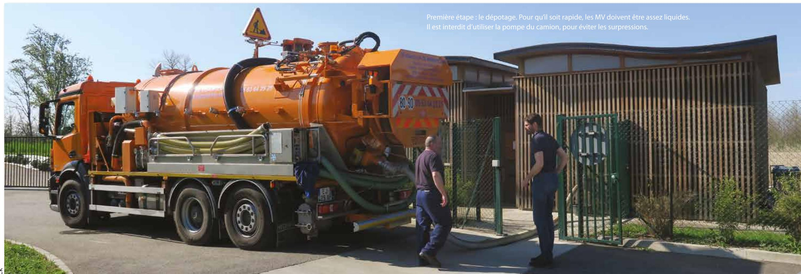
Première étape : le dépotage. Pour qu'il soit rapide, les MV doivent être assez liquides. Il est interdit d'utiliser la pompe du camion, pour éviter les surpressions.
