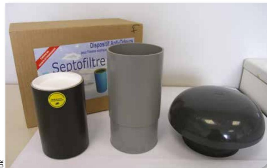
Une réduction concentrique s'emboîte dans un manchon qui reçoit le filtre. Celui-ci se visse ensuite par le bas sur une manchette. Des colliers de fixation peuvent en plus être positionnés pour garantir le maintien de l'ensemble de la colonne.
