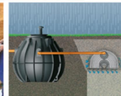
**DRAINMAX TUNNEL** pour rétention et infiltration d'eau de pluie et des eaux usées traitées de la micro-station DELPHIN® compact.
