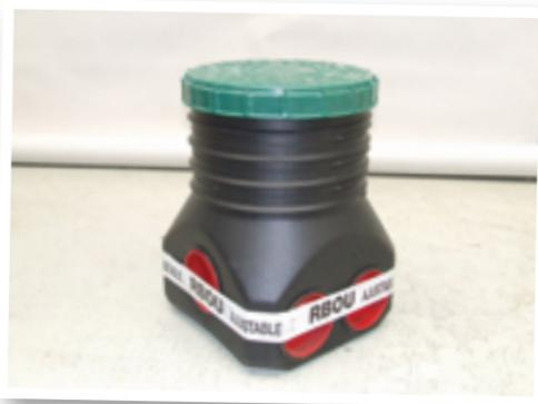
**E**N PLUS de ses dispositifs d'ANC, le fabricant propose une large gamme de boîtes et de regards : pour la visite des effluents, la répartition des eaux prétraitées ou le bouclage des eaux traitées. Tous ces accessoires sont vendus avec des joints hublots siliconés à lèvres rétractables, avec un tampon en plastique à visser.
