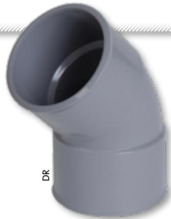
des canalisations, de la sortie à l'extérieur du bâtiment et entre les dispositifs de prétraitement et de traitement. Pour éviter les colmatages et permettre le curage des canalisations, elle conseille à la place d'installer deux coudes successifs de 45° ou un coude à 90° à grand rayon. ●
