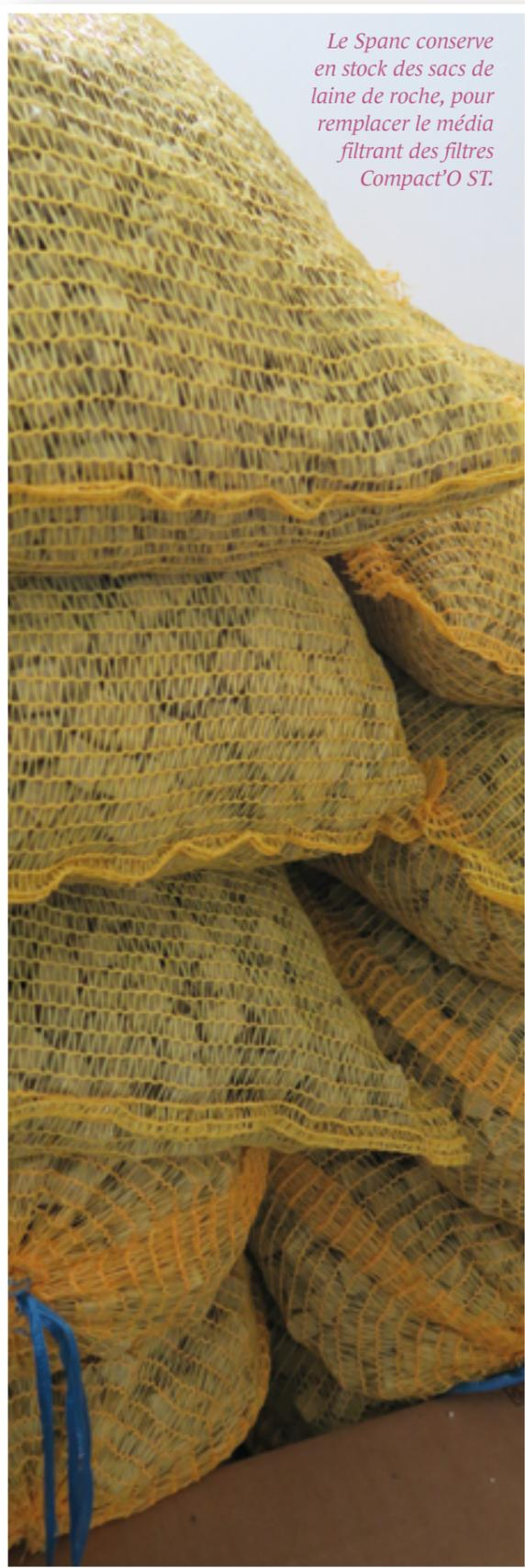
Le Spanc conserve en stock des sacs de laine de roche, pour remplacer le média filtrant des filtres Compact'O ST.
