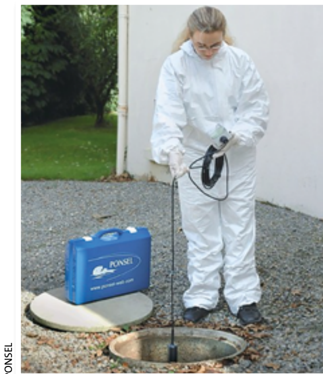
Les sondes pour mesurer le voile de boues font partie des équipements les plus coûteux, leur transport et leur nettoyage sont cependant plus aisés que les autres types d'outils.
