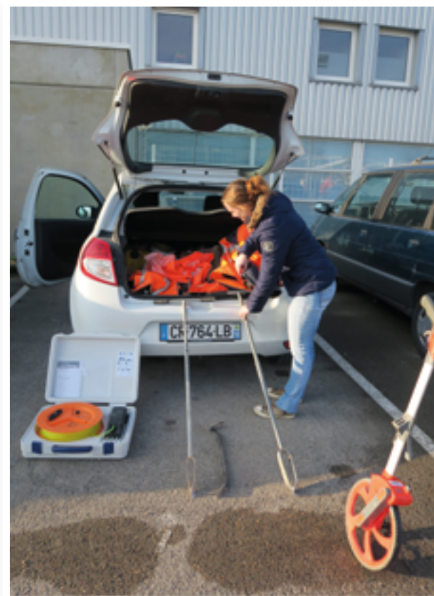
Chaque technicien a son véhicule de service, équipé de tarières manuelles, d'un niveau à bulle, d'une bombe traceuse pour marquer au sol l'emplacement de l'assainissement, d'un télémètre, de fluorescéine, etc.
