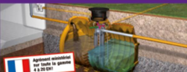
**Micro station d'épuration biologique fonctionnant sur le principe SBR**
