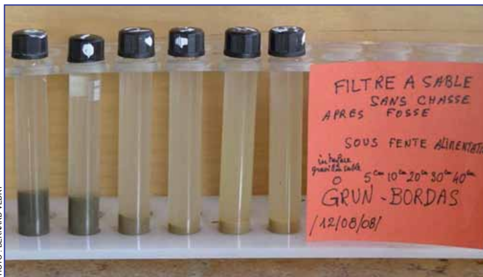
Gradient de la biomasse suivant la profondeur dans un filtre à sable disséqué à Grun-Bordas (Dordogne). On constate qu'elle est surtout présente à l'interface entre les gravillons et le sable et à une profondeur de 5 cm (dans les deux tubes de gauche), qu'elle décroît dès 10 cm de profondeur (dans le troisième tube) et que sa proportion reste constante plus bas (dans les trois tubes de droite).
