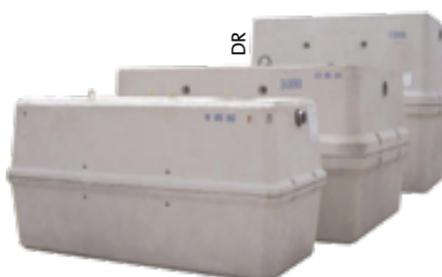
LES FOSSES toutes eaux Gamma s'installent à l'aide d'un palonnier, relié aux quatre boucles de levage prévues à cet effet. Fabriquées en béton à haute résistance, les deux coques qui les constituent sont solidarifiées par collage et les liaisons sont jointes avec des platines boulonnées. Les entrées et les sorties des effluents sont équipées d'un joint souple à lèvres. Un préfiltre composé de pouzzolane est intégré dans chaque fosse, sous la forme d'un panier amovible.
