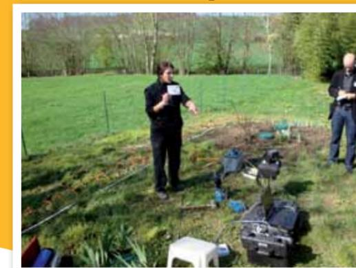
Le second outil est un pénétromètre Panda, pour mesurer la hauteur et la définition des matériaux rencontrés. L'essai consiste à enfoncer, par battage, un train de tiges dans le sol à l'aide d'un marteau normalisé. Pour chaque coup donné, des capteurs mesurent l'énergie fournie par le marteau au moment de l'impact. D'autres capteurs mesurent en même temps la hauteur de l'enfoncement de la pointe. Ces données sont transmises à un ordinateur
