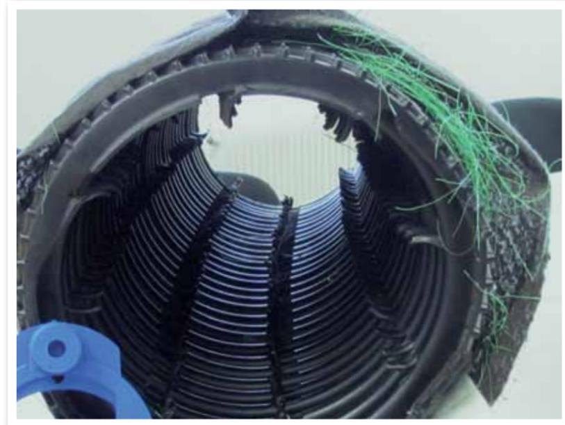
Tout est en plastique : la fibre en PP, couverte d'une housse géotextile, entoure la conduite en PEHD pour faciliter le transport d'oxygène et servir de support à la biomasse.
