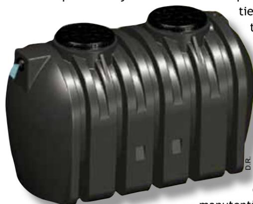
souple à lèvres à l'entrée et à la sortie. Un diffuseur d'entrée évite les turbulences et permet l'amortissement hydraulique des débits de pointe. L'emplacement de la ventilation est prédécoupé. Les deux tampons de visite sont équipés d'un couvercle renforcé à visser, étanche à l'air comme à l'eau. Ils sont équipés de rehausseurs ajustables. Enfin, deux anneaux de levage et quatre poignées facilitent la manutention et la pose. ●
