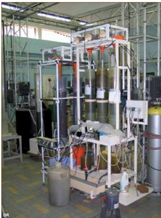
Les cinq colonnes montées en parallèle sur le banc de test.
